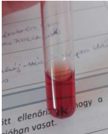
4. kép Vízminta vastartalmának meghatározása klasszikus analitikai módszerrel.
